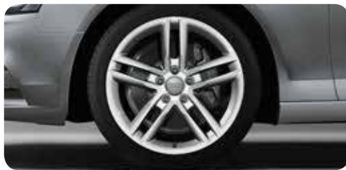
Llantas de fundición de aluminio Audi Sport con diseño de 5 radios dobles tamaño 8 J x 18 con neumáticos 245/40 R 18 1 . Oferta de quattro GmbH
