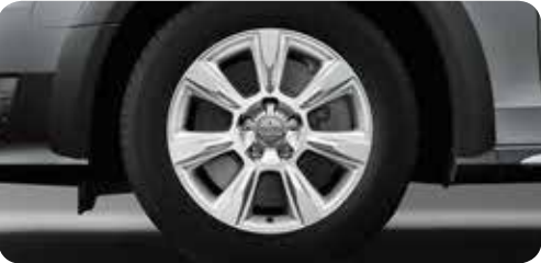
Llantas de fundición de aluminio para invierno con diseño V de 7 brazos tamaño 7,5 J x 17 con neumáticos 225/55 R 17 1 , para cadenas de nieve, velocidad máxima 210 km/h. Sólo para A4 allroad quattro (No disponibles en España)
