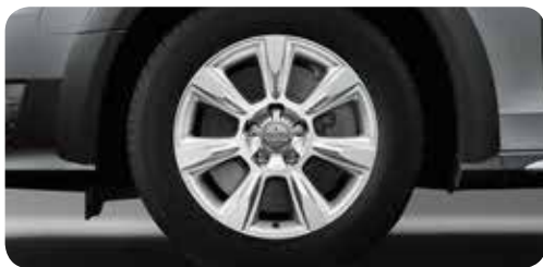
Llantas de fundición de aluminio con diseño de 7 brazos en V tamaño 8 J x 17 con neumáticos 225/55 R 17 1 . Sólo para A4 allroad quattro
