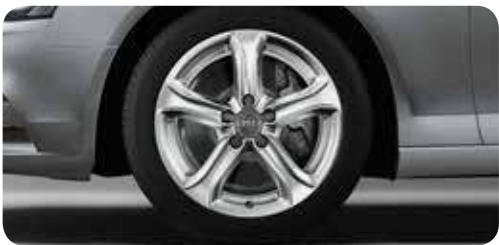
Llantas de fundición de aluminio con diseño de 5 brazos tamaño 7,5 J x 17 con neumáticos 225/50 R 17 1
