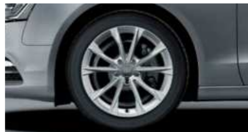
Llantas de aleación en diseño de 5 radios "V" tamaño 8,5 J x 18 con neumáticos 245/40 R 18
