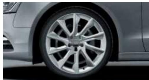
Llantas de aleación en diseño de 10 radios tamaño 8,5 J x 19 con neumáticos 255/35 R 19
