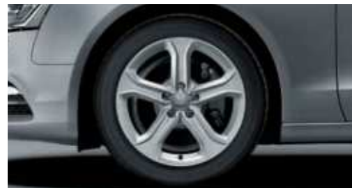
Llantas de aleación en diseño de 5 brazos tamaño 7,5 J x 17 con neumáticos 225/50 R 17
