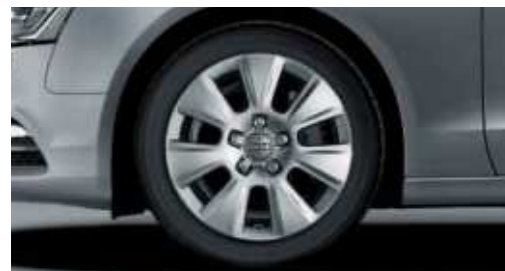
Llantas de aleación en diseño de 7 brazos "Parábola" tamaño 7,5 J x 17 con neumáticos 225/50 R 17
