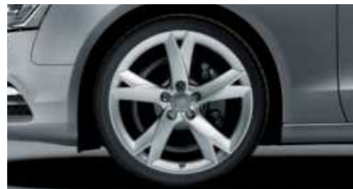
Llantas de aleación en diseño de 5 brazos "Y" tamaño 8,5 J x 19 con neumáticos 255/35 R 19
