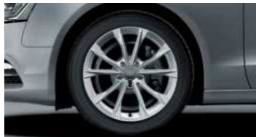
Llantas de invierno de aleación en diseño de 5 radios "V" tamaño 8,5 J x 18 con neumáticos 245/40 R 18, velocidad máxima tolerable 240 km/h, no aptas para cadenas. No disponibles en España.
