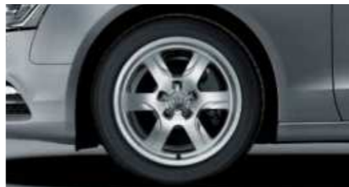
Llantas de invierno de aleación ligera en diseño de 6 brazos, tamaño 7,5 J x 17 con neumáticos 225/50 R 17, velocidad máxima tolerable 210 km/h, aptas para cadenas (como opción con neumáticos de emergencia). No disponibles en España.
