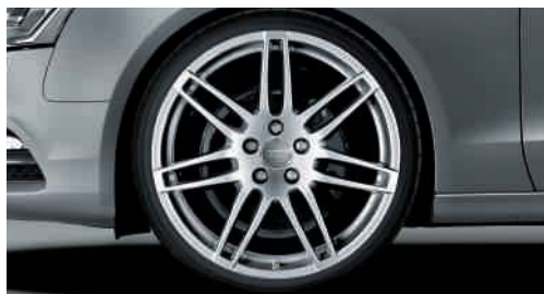
Llantas de aleación de aluminio Audi exclusive con diseño de 7 radios dobles tamaño 9 J x 20 con neumáticos 265/30 R 20. Una oferta de quattro GmbH
