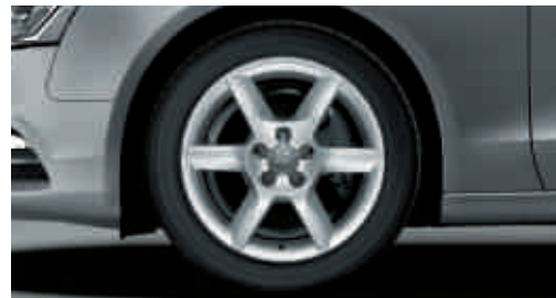
Llantas de aleación en diseño de 6 radios "Parabólico" tamaño 8 J x 17 con neumáticos 245/45 R 17 (como opción con neumáticos de emergencia)
