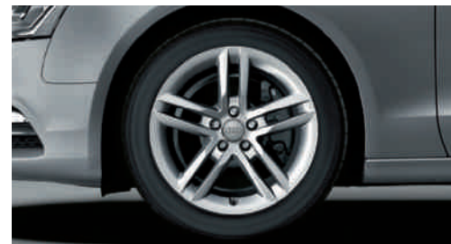
Llantas de aleación Audi exclusive en diseño de 5 radios dobles tamaño 8,5 J x 18 con neumáticos 245/40 R 18 1 Una oferta de quattro GmbH
