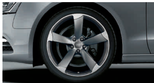
Llantas de aleación Audi exclusive en diseño de 5 brazos "Rotor", en óptica de titanio mate, torneado tamaño 9 J x 19 con neumáticos 255/35 R 19 1 Una oferta de quattro GmbH
