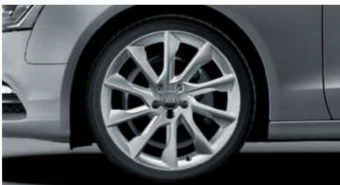
Llantas de aleación en diseño de 10 radios tamaño 8,5 J x 19 con neumáticos 255/35 R 19 1
