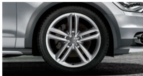
Llantas para invierno de aleación de aluminio con diseño de 5 radios paralelos tamaño 8,5 J x 20 con neumáticos 255/40 R 20, velocidad máxima autorizada 240 km/h. (No disponibles en España).
