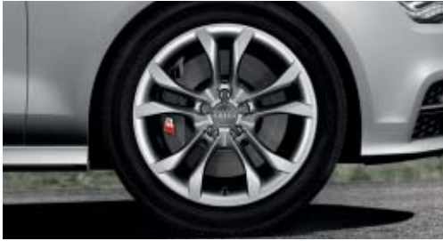
Llantas de aleación de aluminio con diseño de 5 radios paralelos (diseño S) tamaño 8,5 J x 19 con neumáticos 255/40 R 19
