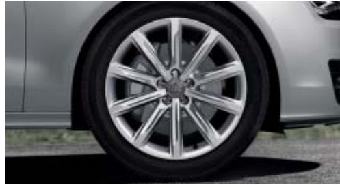
Llantas de aleación de aluminio con diseño de 10 radios, tamaño 8,5 J x 19 con neumáticos 255/40 R 19, con opción de neumáticos de emergencia
