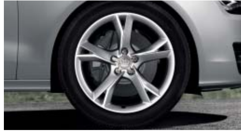
Llantas de aleación de aluminio con diseño de 5 brazos en "Y" tamaño 8,5 J x 19 con neumáticos 255/40 R 19
