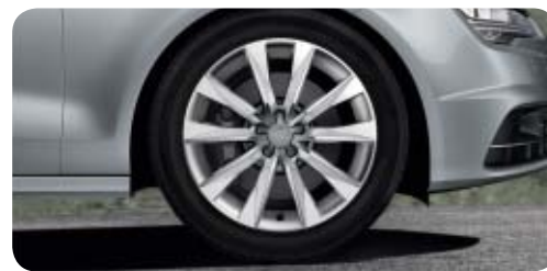
Llantas de aleación de aluminio en diseño de 5 radios "V" tamaño 8,5 J x 19 con neumáticos 255/40 R 19 1 .
