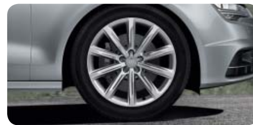
Llantas de aleación de aluminio en diseño de 10 radios tamaño 8,5 J x 19 con neumáticos 255/40 R 19 1 .
