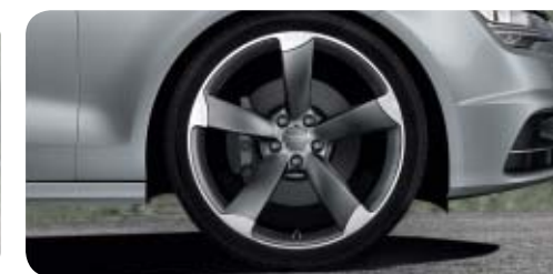
Llantas de aleación de aluminio Audi Sport en diseño de 5 brazos "Rotor" en óptica de titanio mate, torneado brillante 2,3 tamaño 9 J x 21 con neumáticos 275/30 R 21 1 .
