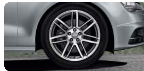
Llantas de aleación de aluminio Audi Sport en diseño de 7 radios dobles 3 tamaño 9 J x 19 con neumáticos 255/40 R 19 1 .
