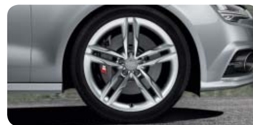
Llantas de aleación de aluminio en diseño de 5 radios paralelos "Estrella"/diseño S" tamaño 9 J x 20 con neumáticos 265/35 R 20 1 . Solo disponible para Audi A7 Sportback.
