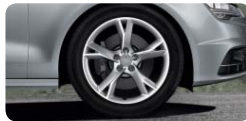
Llantas de aleación de aluminio en diseño de 5 brazos "Y" tamaño 8,5 J x 19 con neumáticos 255/40 R 19 1 .
