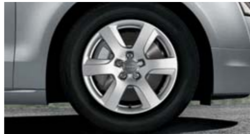
Llantas de aleación ligera en diseño de 6 brazos, tamaño 8 J x 17 con neumáticos 235/60 R 17 (De serie en el 4.2 FSI)
