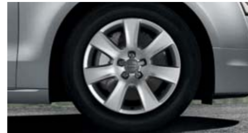
Llantas de invierno de aleación ligera en diseño de 7 brazos, tamaño 7,5 J x 18 con neumáticos 235/55 R 18, aptas para cadenas, velocidad máxima tolerable 210 km/h (No disponibles en España)
