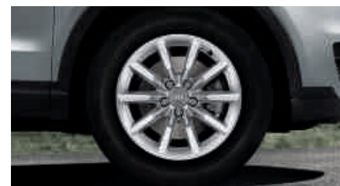
Llantas de aleación de aluminio con diseño de 10 radios tamaño 7 J x 17 con neumáticos 235/55 R 17
