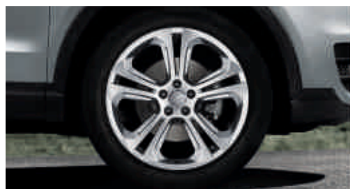
Llantas de aleación de aluminio Audi exclusive con diseño "Offroad" de 5 radios dobles* tamaño 8,5 J x 19 con neumáticos 255/40 R 19, incluye pasos de rueda ensanchados. Una oferta de quattro GmbH
