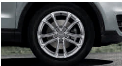
Llantas de aleación de aluminio con diseño de 5 radios dobles tamaño 7 J x 18 con neumáticos 235/50 R 18
