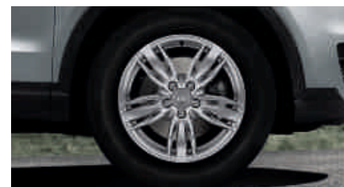
Llantas de aleación de aluminio con diseño "Trias" de 5 brazos tamaño 7 J x 17 con neumáticos 235/55 R 17
