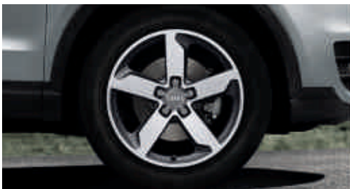
Llantas de aleación de aluminio con diseño de 5 brazos pulidas parcialmente, tamaño 7 J x 18 con neumáticos 235/50 R 18
