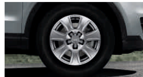
Llantas forjadas de aluminio con diseño de 7 brazos tamaño 6,5 J x 16 con neumáticos 215/65 R 16
