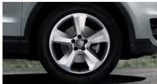
Llantas de aleación de aluminio Audi exclusive con diseño "Offroad" de 5 brazos* tamaño 7 J x 18 con neumáticos 235/50 R 18. Una oferta de quattro GmbH
