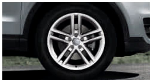
Llantas de aleación de aluminio Audi exclusive con diseño de 5 radios dobles tamaño 7 J x 18 con neumáticos 235/50 R 18. Una oferta de quattro GmbH
