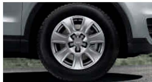
Llantas para invierno forjadas de aluminio con diseño de 7 brazos tamaño 6,5 J x 16 con neumáticos 215/65 R 16, aptas para cadenas, velocidad máxima autorizada de 210 km/h
