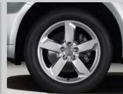
Llantas de aleación en diseño de 5 brazos, pulidas, tamaño 8 J x 19 con neumáticos 235/55 R 19.
