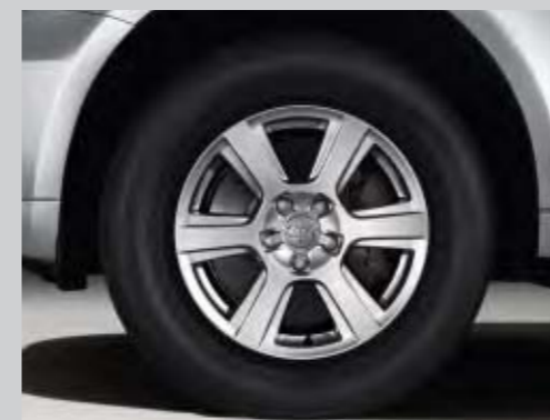
Llantas de aleación en diseño de 6 brazos, tamaño 8 J x 17 con neumáticos 235/65 R 17.
