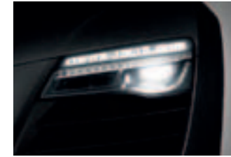
Luz de cruce compuesta por 6 LEDs y un punto luz de cruce
