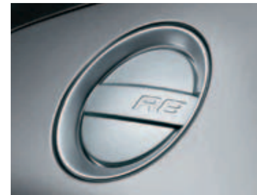
Tapa del depósito de combustible de aluminio Con inscripción R8 y desbloqueo eléctrico.
