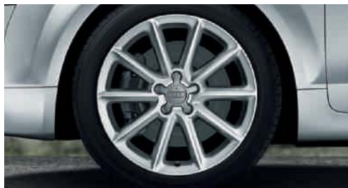
Llantas de aleación con diseño de 10 radios, tamaño 9 J x 18 con neumáticos 245/40 R 18 (Para Audi TT)
