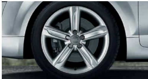
Llantas de aleación con diseño de 5 brazos “dynamic”, tamaño 9 J x 18 con neumáticos 245/40 R 18, de forma alternativa con neumáticos con propiedades de rodadura de emergencia (Para Audi TT)
