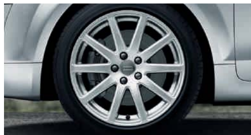
Llantas de invierno de aleación con diseño de 10 radios, tamaño 9 J x 18 con neumáticos 245/40 R 18, aptas para cadenas, velocidad máxima tolerable 240 km/h, como opción con neumáticos con propiedades de rodadura de emergencia (Para Audi TT) (No disponibles en España)
