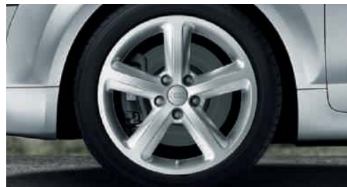
Llantas de aleación Audi exclusive con diseño de 5 brazos, tamaño 9 J x 18 con neumáticos 245/40 R 18 Una oferta de quattro GmbH (Para Audi TT)
