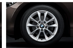
■ Llantas de aleación ligera de 16 pulgadas con radios en V estilo 411, 7 J x 16, neumáticos 205/55 R 16.
