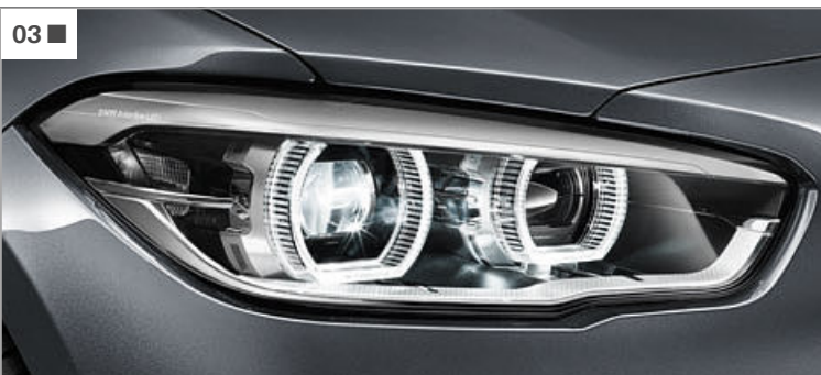
[ 03 ] Faros delanteros con tecnología LED, incluyendo 8 LED de potencia para función de luz de cruce y de carretera.
