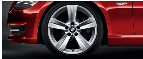
□ Llantas de aleación ligera de 18 pulgadas estilo 189. Radios en estrella, con neumáticos de distintas medidas, delante 8 J x 18, neumáticos 225/40 R 18, detrás 8,5 J x 18, neumáticos 255/35 R 18.
