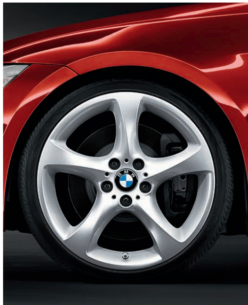
□ Llantas de aleación ligera de 19 pulgadas estilo 230 i . Radios en estrella, con neumáticos de distintas medidas, delante 8 J x 19, neumáticos 225/35 R 19; detrás 9 J x 19, neumáticos 255/30 R 19.
