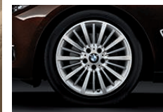
■ Llantas de aleación ligera de 18 pulgadas con radios múltiples estilo 416, con pulido de brillo intenso, 8 J x 18, neumáticos 225/50 R 18.
