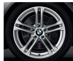
■ Llantas de aleación ligera M de 18 pulgadas estilo 613 M. Radios dobles, con neumáticos de distintas medidas y funcionamiento en caso de avería, delante 8 J x 18, neumáticos 245/45 R 18.
