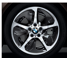
□ Llantas de aleación ligera de 18 pulgadas estilo 364. Aerodinámicas, con funcionamiento en caso de avería, 8 J x 18, neumáticos 245/45 R 18.
