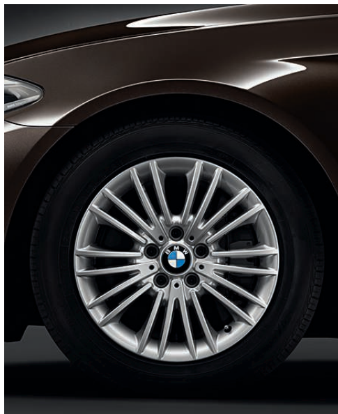
□ Llantas de aleación ligera de 17 pulgadas estilo 456. Radios múltiples, con funcionamiento en caso de avería, 8 J x 17, neumáticos 225/55 R 17.
