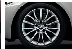
■ Llantas de aleación ligera de 18 pulgadas con radios múltiples estilo 454, con funcionamiento en caso de avería, 8 J x 18, neumáticos 245/45 R 18.
