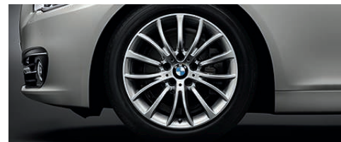
■ Llantas de aleación ligera de 18 pulgadas estilo 454. Radios múltiples con funcionamiento en caso de avería, 8 J x 18, neumáticos 245/45 R 18.
