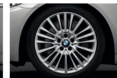
□ Llantas de aleación ligera de 19 pulgadas con radios múltiples estilo 455, con funcionamiento en caso de avería, 8,5 J x 19, neumáticos 245/40 R 19.
