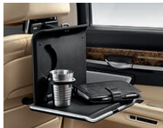
Mesa abatible, sistema Travel & Comfort. Ofrece a los ocupantes de las plazas traseras una superficie práctica, regulable tanto en altura como en el ángulo de inclinación.
