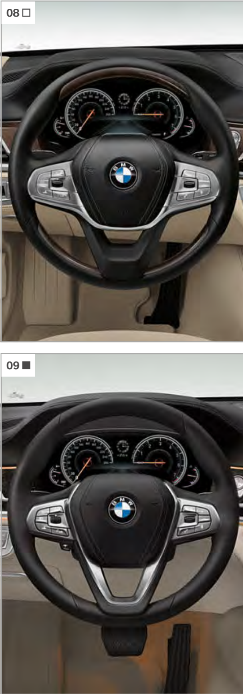
[ 08 ] El volante de cuero con detalles de madera³ presenta detalles parciales en madera en el aro del volante de cuero y un absorbedor de impacto en cuero Nappa con costuras de contraste.
