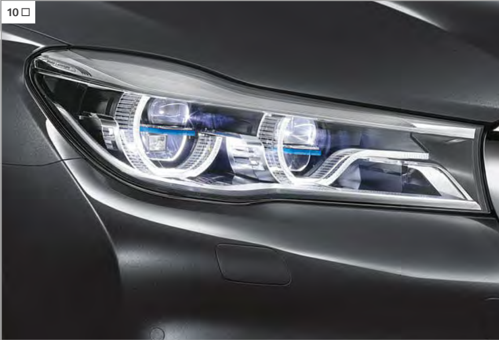
[ 08 ] Los faros LED autoadaptables, con luz de giro y BMW Selective Beam (asistente de luz de carretera antideslumbramiento), ofrecen en cualquier situación una mejor iluminación y visibilidad que los sistemas convencionales. [ 09 ] El sistema Air Breather canaliza el aire en la zona de las ruedas delanteras, reduciendo la resistencia y los niveles de consumo y emisiones de CO 2 .
