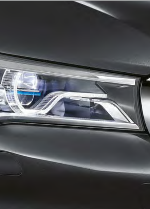
[ 09 ] Los faros LED autoadaptables, con luz de giro y BMW Selective Beam (asistente de luz de carretera antideslumbramiento), ofrecen en cualquier situación una mejor iluminación y visibilidad que los sistemas convencionales.
