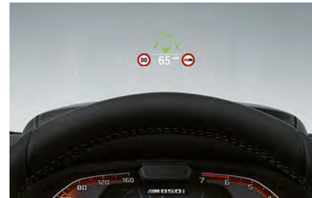
EL BMW HEAD-UP DISPLAY A TODO COLOR PROYECTA LA INFORMACIÓN RELEVANTE PARA LA CONDUCCIÓN DIRECTAMENTE EN EL CAMPO VISUAL DEL CONDUCTOR, SIN DISTRACCIONES.
