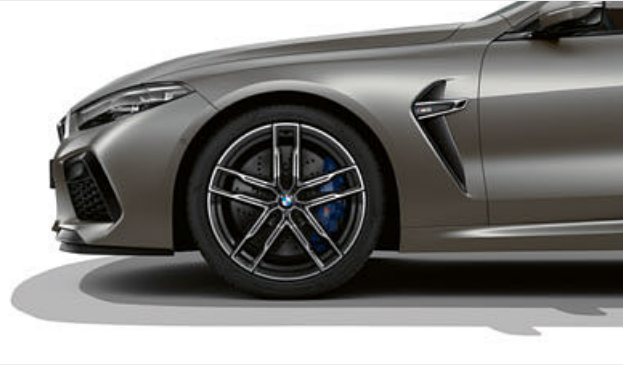
Llantas de aleación ligera M de 20 pulgadas con radios dobles estilo 810 M. Llantas de aleación ligera M de 20 pulgadas con radios dobles estilo 810 M, en bicolor Orbitgrau, con neumáticos de distintas medidas, pulido brillante, delante 9,5 J x 20, neumáticos 275/35 R 20, detrás 10,5 J x 20, neumáticos 285/35 R 20.
