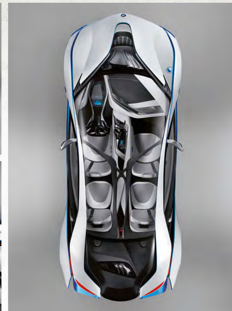
El prototipo de 2+2-plazas ya presentaba en 2009 la forma cónica, cuya aerodinámica se inspiraba en la gota de agua.
