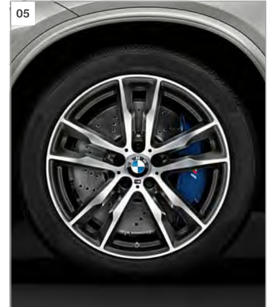
[ 05 ] Llantas de aleación ligera M de 20 pulgadas con radios dobles estilo 611 M, pulido brillante, con neumáticos de distintas medidas, delante 10 J x 20, neumáticos 285/40 R 20, detrás 11,5 J x 20, neumáticos 325/35 R 20.
