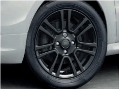
Llantas de aleación de 40,64cm (16") y 7 radios pintadas en 'Gris Magnetic' (de serie)
