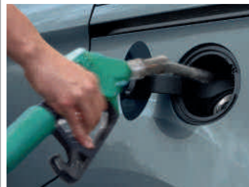
Sistema de repostaje sin tapón Easy Fuel de Ford (de serie)
