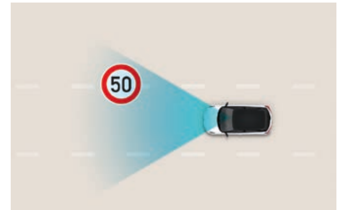
Asistente inteligente de límite de velocidad (ISLA). Este sistema emite alertas acústicas y visuales si circulas por encima de la velocidad permitida en la vía. Cuando se combina con el limitador manual de velocidad o el control de crucero inteligente, ISLA puede incluso ajustar la velocidad de forma autónoma.
