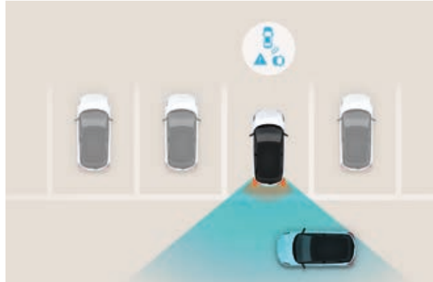
Alerta de aproximación de tráfico trasero activo (RCCA). Al dar marcha atrás en zonas de poca visibilidad, el sistema te avisa si se aproximan vehículos por el lateral y activa los frenos de forma automática si fuera necesario.
