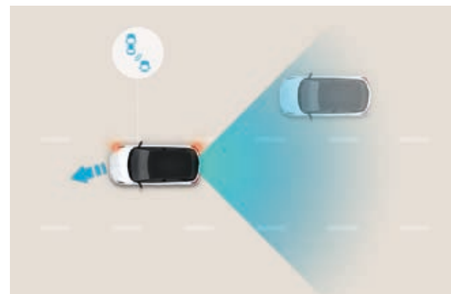
Sistema de detección de ángulo muerto (BCA). Para una mayor seguridad con tráfico intenso, el BCA emite una alerta, acciona automáticamente los frenos de la izquierda o la derecha y asume el control de la dirección si detecta un vehículo en el ángulo muerto e inicia la maniobra para cambiar de carril.
