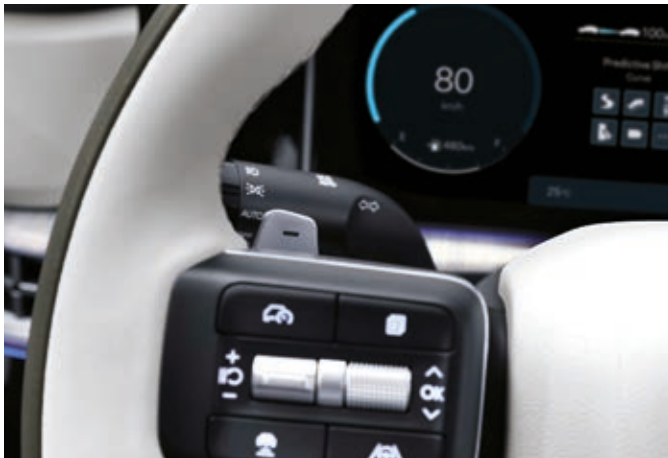
Características exclusivas del híbrido Paddle Shift (levas) - Modo de frenado regenerativo
