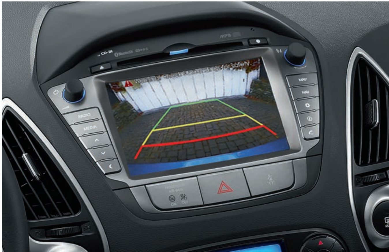
Cámara de visión trasera. Al poner la marcha atrás, la cámara proyecta la imagen del área situada detrás del vehículo en la pantalla de navegación TFT-LCD de 7 pulgadas.
