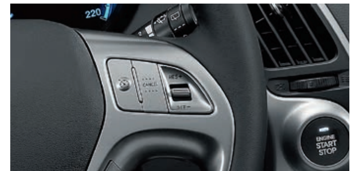
Control de crucero. Con solo ajustar la velocidad deseada, el coche la mantendrá hasta que pises el freno, aceleres o cambies de marcha. También puedes programar la función de limitación de velocidad para evitar aceleraciones involuntarias.
