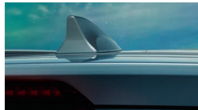
Antena en forma de aleta de tiburón. El sistema de navegación incorpora antena de "aleta de tiburón" que sustituirá a la antena estándar.
