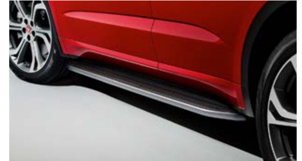
Estribos laterales fijos
