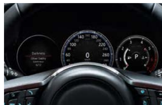
Panel de instrumentos digital de 12,3 pulgadas con diales virtuales
