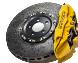
FRENOS CARBOCERÁMICOS CON DISCOS DELANTEROS DE 398 MM Y TRASEROS DE 380 MM
