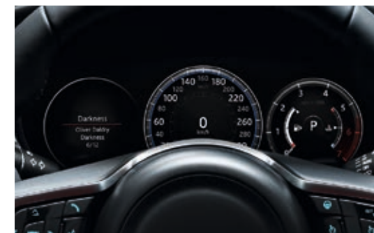
Panel de instrumentos digital de 312 mm (12,3") con diales virtuales
