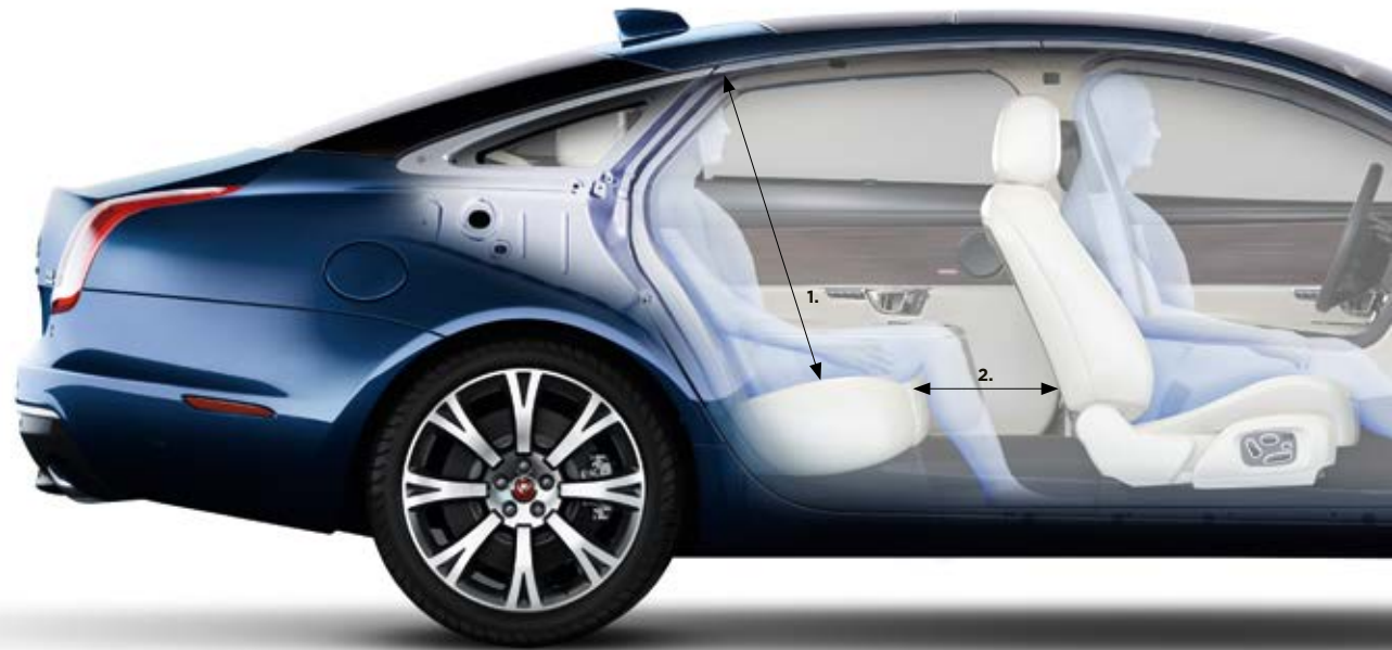
1. Altura interior de la versión LWB: 946 mm 2. Espacio para las rodillas en la versión LWB: 189 mm
