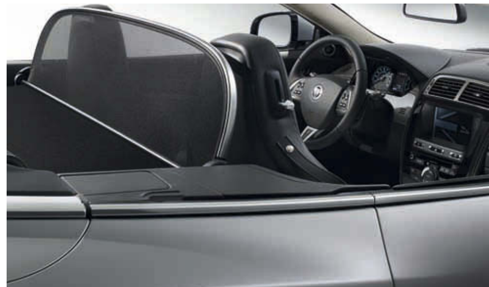
DEFLECTOR DE AIRE Proporciona un gran confort en la conducción con la capota abierta y reduce el viento en el habitáculo interior. El deflector de aire extraíble en aluminio pulido está también disponible en color negro. Acabado en negro: C2P2440 Acabado brillante: C2P17566
