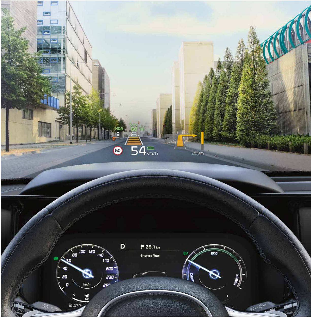
Head-up display (HUD). Mantente sano y salvo: para garantizar que mantienes la vista en la carretera, el HUD proyecta gráficos y otra información relacionada con la conducción en el parabrisas, directamente en tu campo visual. (Equipamiento según versión).
