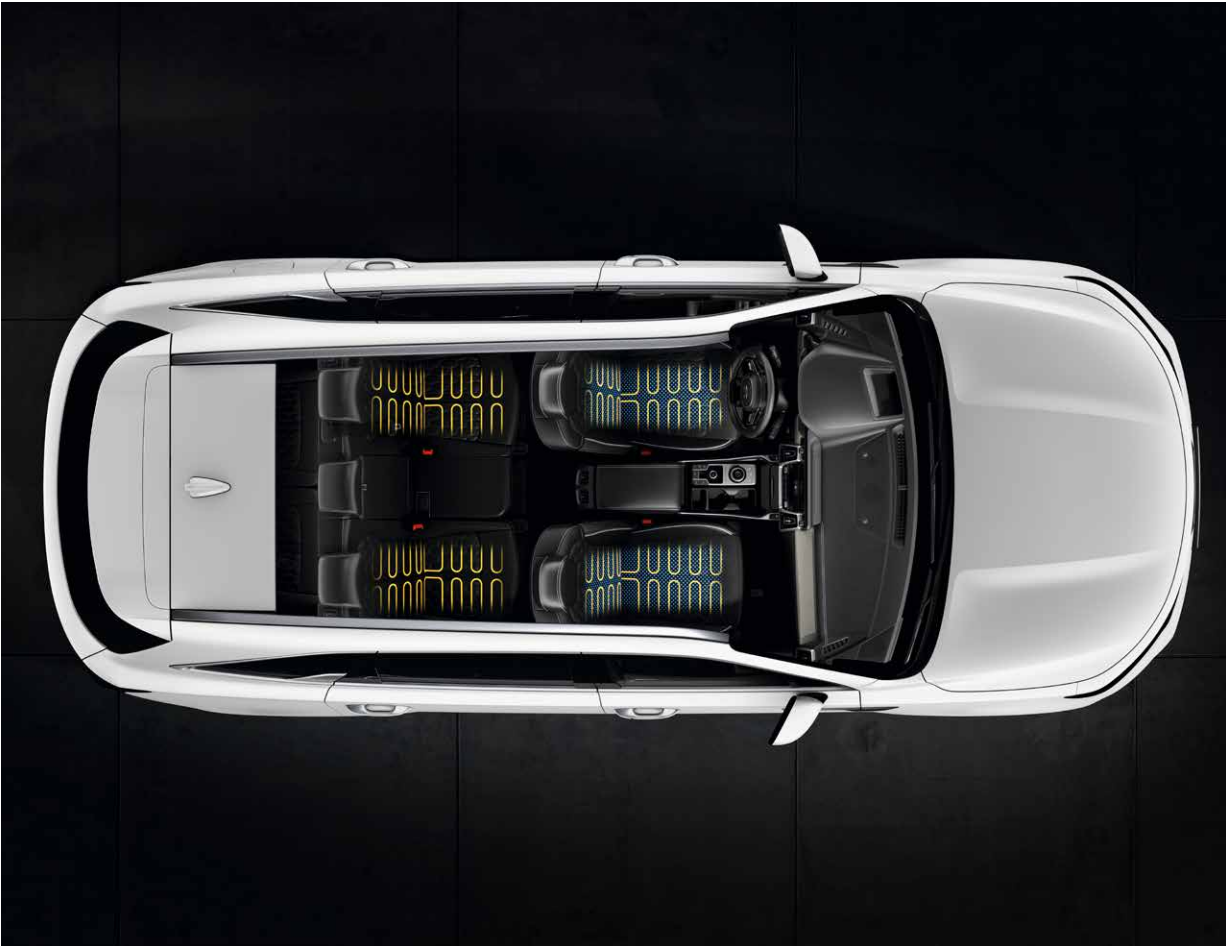
Asientos calefactados y con ventilación. Cuando afuera hace frío, el asiento y el respaldo de la primera y la segunda fila se pueden calentar. En los días más cálidos, el conductor y el pasajero delantero podrán disfrutar de la ventilación de los respaldos. (Equipamiento según versión).
