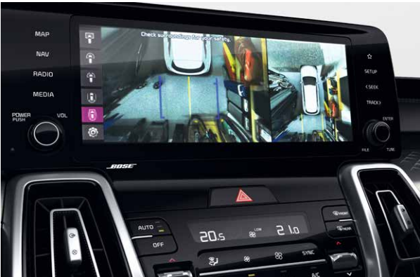
Cámara de visión 360°. Seguridad en todas partes: este sistema intuitivo combina cuatro imágenes en gran angular procedentes de las cámaras frontal, trasera y laterales del vehículo para ofrecerte una vista aérea completa del espacio que rodea al Sorento, mientras aparcas o conduces a menos de 20 km/h. (Equipamiento según versión).
