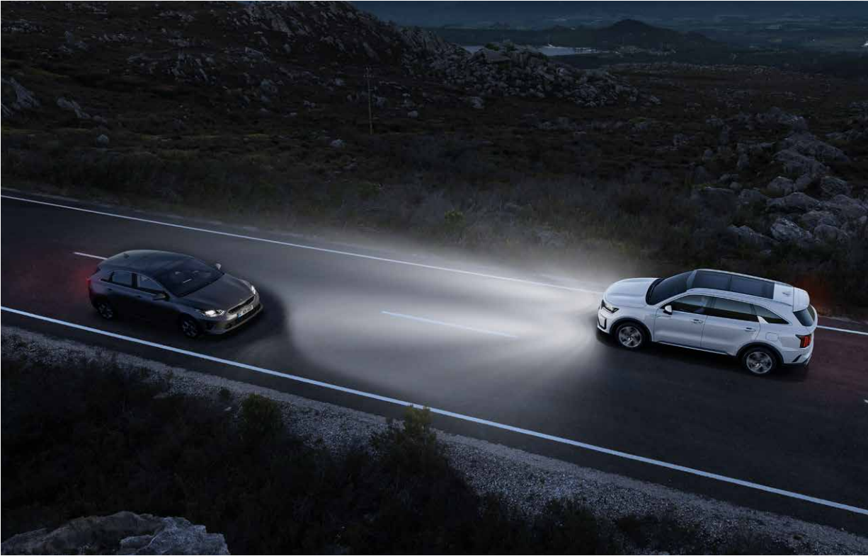
Asistente de luces de carretera (HBA). Cuando las condiciones lo permitan, el Sorento encenderá las luces largas automáticamente. Cuando la cámara del parabrisas detecta las luces de un vehículo que se acerca de noche, el asistente de luces de carretera cambia automáticamente la luz de carretera a luz de cruce para evitar deslumbrar a los demás conductores.
