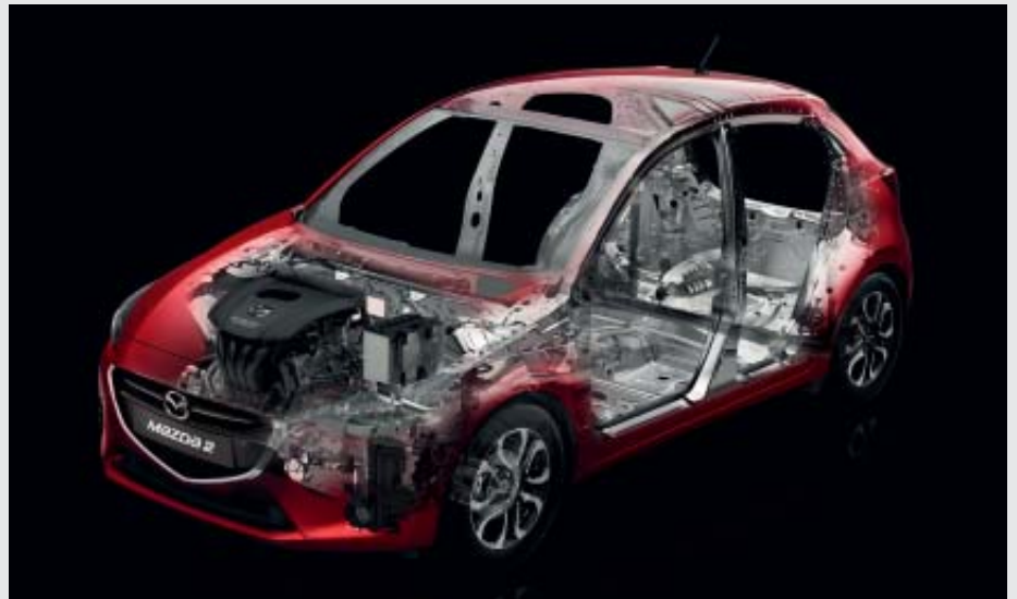
CHASIS RÍGIDO Y LIGERO DE UNA PIEZA PARA UNA SÓLIDA SEGURIDAD PASIVA
