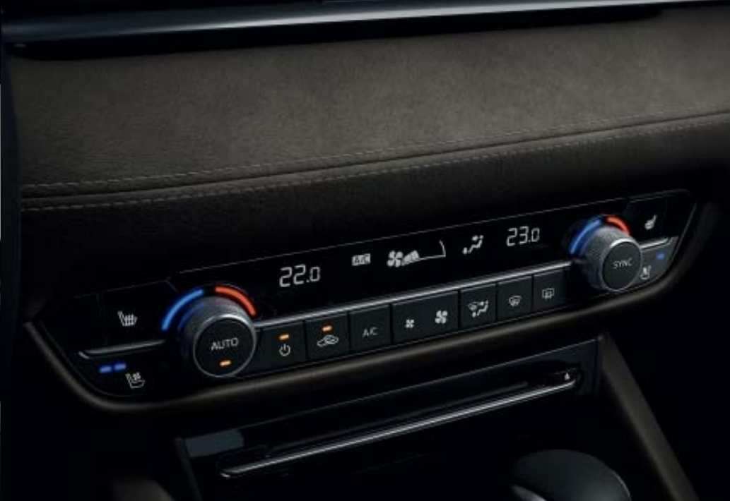
CLIMATIZADOR AUTOMÁTICO BIZONA
