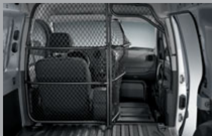
Rejilla de protección. La rejilla opcional aumenta la longitud de carga en el furgón, a la vez que protege a los ocupantes.
