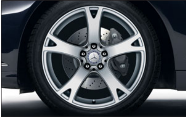
Llanta de aleación de 5 radios con neumáticos 255/40 R 19 delante y 275/40 R 19 detrás (opcional).
