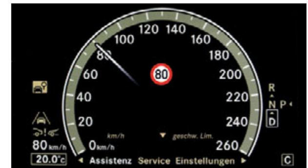
Indicación de la velocidad límite en el cuadro de instrumentos.
