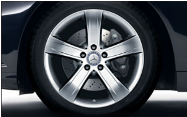
Llanta de aleación de 5 radios con neumáticos 255/45 R 18 (de serie para modelos V8).
