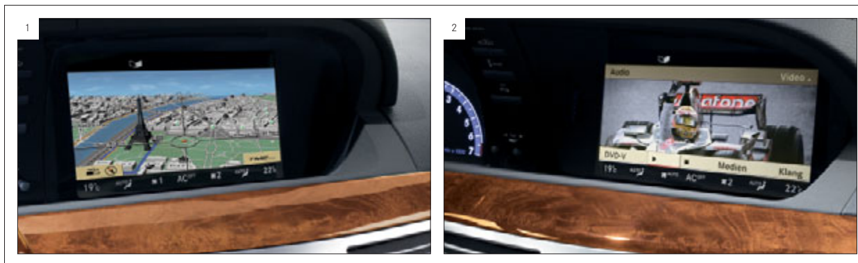
SPLITVIEW visualiza simultáneamente contenidos diferentes para el conductor (1) y el acompañante (2) en una misma pantalla.
