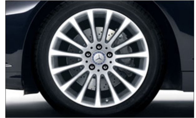
Llanta de aleación en diseño multirradio con neumáticos 255/45 R 18 delante y 275/45 R 18 detrás (opcional).
