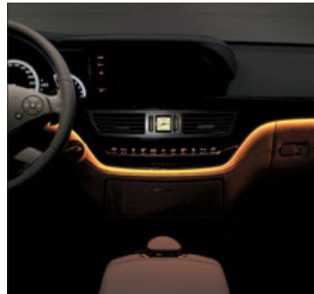
La iluminación de ambiente es una estrecha banda luminosa de LED que se ilumina en tres tonalidades.
