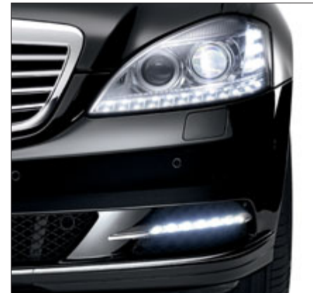
El paquete de alumbrado LED con Intelligent Light System y luz diurna de diodos luminosos.
