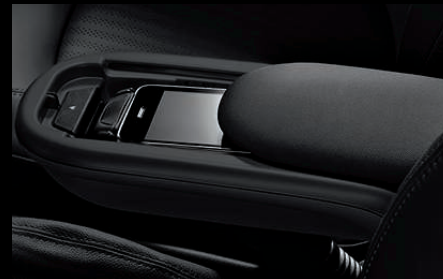
7. Preinstalación para móvil Bluetooth con interfaz USB-audio
