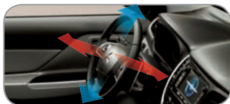
Volante regulable en altura y profundidad
