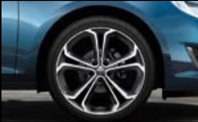
Llantas de aleación 8 J x 19", con 5 radios y acabado bitono. Neumáticos 235/40 R 19 (PZT).
