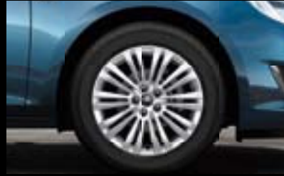
Llantas de aleación 7 J x 17", con 10 radios dobles. Neumáticos 215 (225)/50 R 17 (PXS).
