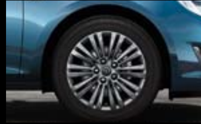
Llantas de aleación 7 J x 17" con 10 radios dobles y acabado Titanio. Neumáticos 215 (225)/50 R 17 (PWW).
