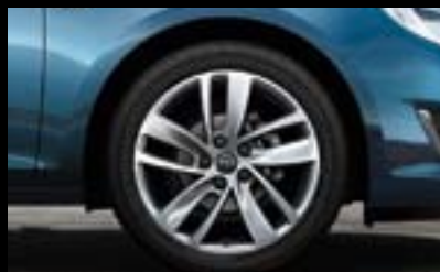
Llantas de aleación 7,5 J x 18" y 8 J x 18", con 5 radios divididos. Neumáticos 225/45 R 18 ó 235/45 R 18 (RT1) y (PTW).
