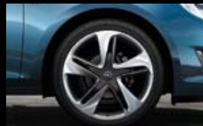
Llantas de aleación 8 J x 19", con 5 radios. Neumáticos 235/40 R 19 (Q1D).
