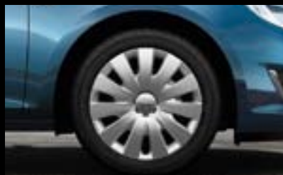
Llantas de acero 6,5 J x 16" y 7 J x 17", con embellecedor. Neumáticos 205 (215)/60 R 16 ó 215 (225)/50 R 17 (PWM) y (PWP).
