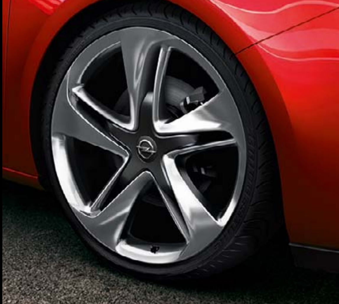
Llantas de aleación 8,5 J x 20". Diseño de 5 radios. Neumáticos 245/40 R 20 (RQ9 1 ).
