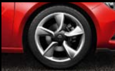
Llantas de aleación 8 J x 19". Diseño de 5 radios. Neumáticos 235/45 R 19 (RT8).
