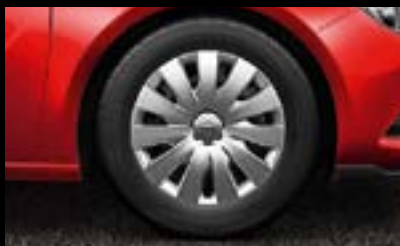
Llantas de acero 7J x 17". Con embellecedor. Neumáticos 235/55 R 17 (PWP). De serie en Selective.
