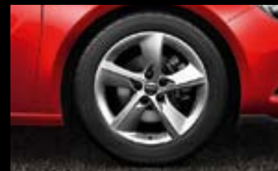
Llantas de aleación 7,5 J x 18". Diseño de 5 radios. Neumáticos 235/50 R 18 (RSZ). De serie en BiTurbo.
