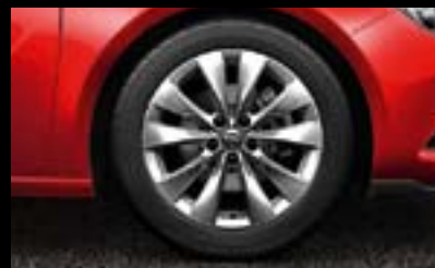
Llantas de aleación 7,5 J x 18". Diseño multi-radio. Neumáticos 235/50 R 18 (RQJ). De serie en Sportive.
