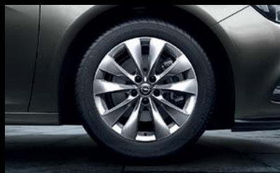
Llantas de aleación 7,5J x 18", diseño multi-radio. Neumáticos 235/50 R 18 (RQJ).
