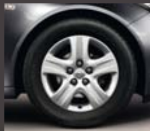
2 Lantas Design 7 J x 17", con embellecedor de 5 radios. Neumáticos: 225/55 R 17 (QR8).
