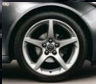
⑦ Llantas de aleación 8,5 J x 19", con diseño de 5 radios y lacado premium multicapa. Neumáticos: 245/40 R 19 (Q93).
