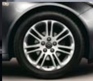
⑥ Llantas de aleación 8 J x 18", con diseño de 7 radios dobles. Neumáticos: 245/45 R 18 (Q60).
