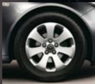
3 Lantas de aleación 7 J x 17", con diseño de 7 radios. Neumáticos: 225/55 R 17 (Q00).
