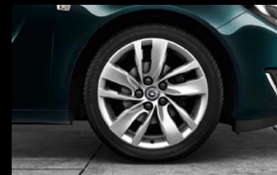
Llantas de aleación 8 J x 18", diseño multi-radio, neumáticos 245/45 R 18 (PXR).
