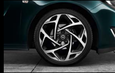
Llantas de aleación 8,5 J x 19" OPC, diseño multi-radio bitono, neumáticos 245/40 R 19 (Q7P). Solo con Super Sport Chasis.
