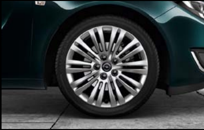
Llantas de aleación 8 J x 18", diseño multi-radio, neumáticos 245/45 R 18 (RT4).
