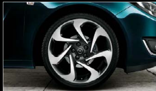
Llantas de aleación 8,5 J x 20", diseño de 7 radios en forma de ala, acabado bitono, neumáticos 245/35 R 20 (Q7R).
